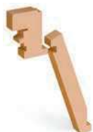
Tapée intérieure rapportée pour isolation de 200 mm
