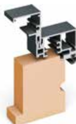
Oscillo coulissant : Tapée extérieure rapportée pour isolation de 80 à 190 mm sur l'ouvrant 69 mm
